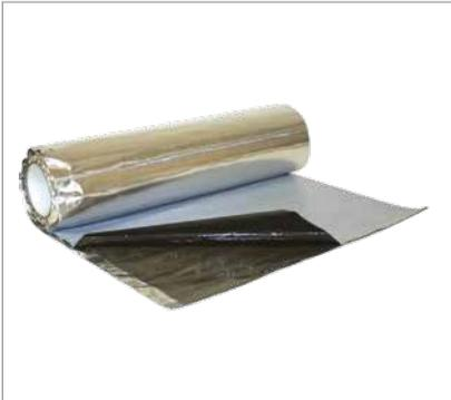
DRG-Alu Sound ist eine selbstklebende Butylbahn, die vibrationsdämpfend ist. Die Bahn besteht aus einem vibrationselastischen Butylcompound, das mit einer metallischen Aluminiumfolie kaschiert ist. Sie dämpft Vibrationen und dissipiert diese (bei einer Temperatur von -30°C bis +80°C).
