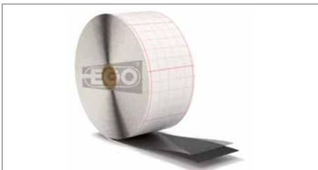
EGOTAPE 1000 ist ein volumenbeständiges, selbstklebendes und plastisches Butyldichtungsband. Das Produkt ist mit einer hochflexiblen und zweidimensional bis zu 300 % dehnbaren, transparenten PE-Folie kaschiert. Die Folie dient primär zum Applizieren des Bandes, die Abdichtung übernimmt das Butyl.
