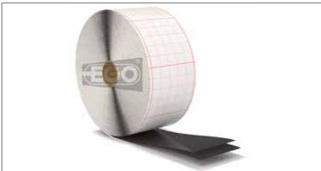
EGOTAPE 4000 ist ein selbstklebendes, volumenbeständiges Butylband, das mit einer anthrazitfarbenen, hochreißfesten HDPE-Folie kaschiert ist. Die Spezialfolie ist kreuzlaminiert und verfügt dadurch über eine hohe Weiterreißfestigkeit.
