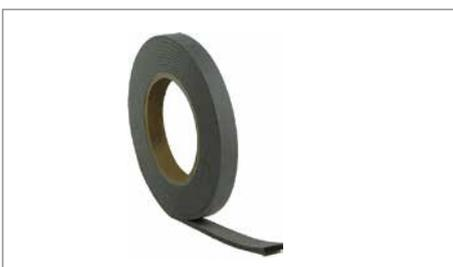
Das DRG-Vorkomprimierte Fugendichtband BG2 (300 Pa) aus imprägniertem Schaumstoff wird zur Abdichtung von Anschlüssen zwischen Fassadendämmsystemen und angrenzenden Bauteilen verwendet. Durch das spezielle Expansionsverhalten ist es für die Erstellung komplexer Anschlüsse (z.B. von Fensterbänken) geeignet.
