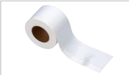
DRG-Fensteranschlussfolie außen besteht aus einem überputzbaren Vliesverbund mit 1 SK-Streifen wahlweise mit Butylstreifen einseitig oder wechselseitig kaschiert. Die Anschlussfolie Außen dient zur schnellen und sicheren äußeren, schlagregendichten und diffusionsoffenen Abdichtung von Fensteranschlußfugen und wird als überputzbare äußere Abdichtung verwendet werden.
