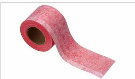
DRG-Fensteranschlussfolie innen besteht aus einem überputzbaren Vliesverbund mit 1 SK-Streifen wahlweise mit Butylstreifen einseitig oder wechselseitig kaschiert. Die Anschlussfolie Innen dient zur schnellen und sicheren inneren, luftdichten und dampfbremsenden Abdichtung von Fensteranschlussfugen und kann auch als überputzbare innere Abdichtung verwendet werden.
