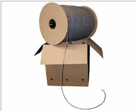
DRG-PE-Rundprofil wird speziell für die Hinterfüllung von kalt verarbeitbarer Fugenmasse hergestellt. Sie hat die Aufgabe die Haftung der Dichtmasse am Fugengrund zu vermeiden und stellt darüber hinaus die erforderliche Vergusstiefe sicher.
