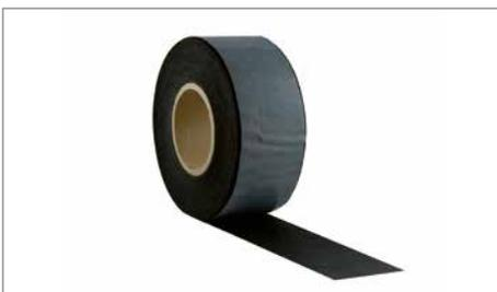
DRG-Fensteranschlussfolie VARIO besteht aus einem überputzbaren Vliesverbund einseitig oder wechselseitig mit Butyl- bzw. Selbstklebung kaschiert. Die Anschlussfolie dient zur schnellen und sicheren inneren, luftdichten und dampfbremsenden Abdichtung von Fensteranschlußfugen und kann auch als überputzbare innere Abdichtung verwendet werden.
