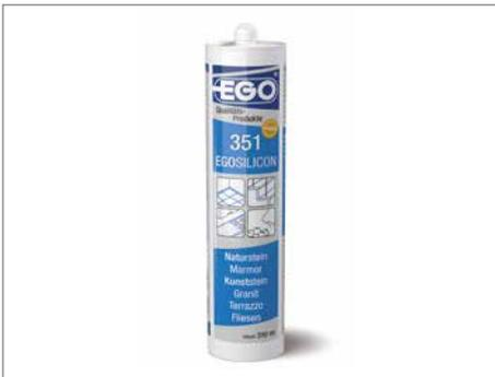
EGOSILICON 351 Natursteinsilicon ist ein hochwertiger, weichmacherfreier Einkomponenten-Dichtstoff zum dauerhaften Abdichten von Anschluss- und Bewegungsfugen im gesamten Naturstein- und Kunststeinbereich. Das Silicon ist witterungs-, alterungs- sowie UV-beständig und kann auch mit matten Farben eingestellt werden. Das Produkt ist frei von 2-Butanonoxim (MEKO) sowie von Methyliso-butylketoxim (MIBKO) und zeichnet sich durch seinen verbesserten Geruch aus.
