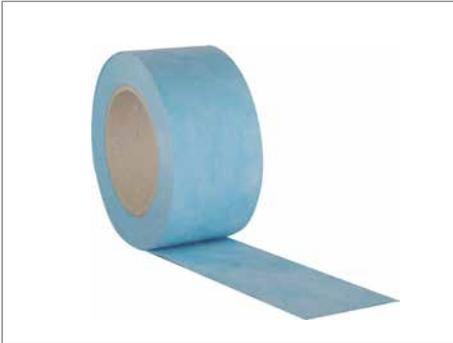
Die DRG-Fensteranschlussfolie FAB 1500 ist die wasserdampfdurchlässige Überbrückung der Fuge zwischen Fenster, Tür und Mauerwerk. Es wird auch im Metall- und Wintergartenbau eingesetzt. Die Klebetechnik ermöglicht eine hohe Flexibilität bei der Verarbeitung des Dichtbandes. Produkte mit einem SD-Wert von  $>1500$  m werden als undurchlässig definiert, Produkte mit einem SD-Wert  $<0,5$  m als durchlässig angesehen. Produkte im Zwischenbereich werden als Diffusion definiert.
