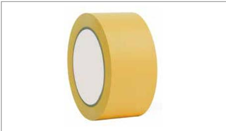
Schmiegsames gelbes Abdeckband, leicht abreibar durch Querrillung, Alterungs- und UV-beständig, für Innen- und Außenbereich, gute Verarbeitung bei niedrigen Temperaturen, für Gips- und Verputzarbeiten und bis 2 Monate rückstandsfrei entfernbar. Von -6 bis +60 C° temperaturbeständig. (Bitte vorher prüfen!)
