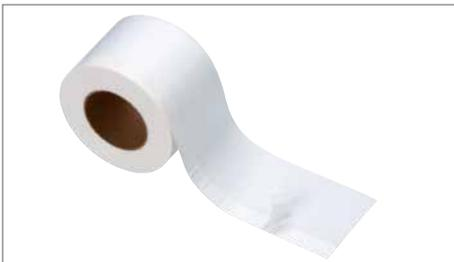
DRG-Fensteranschlussfolie außen besteht aus einem vollflächig selbstklebend überputzbaren Vliesverbund mit 1 SK-Streifen wahlweise mit Butylstreifen einseitig oder wechselseitig kaschiert. Die Anschlussfolie Außen dient zur schnellen und sicheren äußeren, schlagregendichten und diffusionsoffenen Abdichtung von Fensteranschlußfugen und wird als überputzbare äußere Abdichtung verwendet werden.
