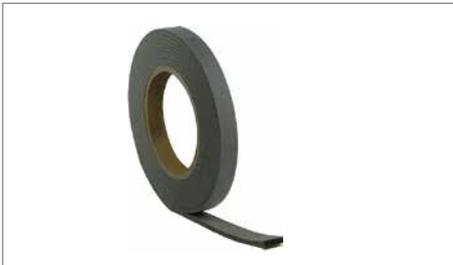
Das DRG-Vorkomprimierte Fugendichtband BG1 (600 Pa) aus imprägniertem Schaumstoff dient zur Primärabdichtung bei direkt bewitterten Fugen und Anschlüssen zwischen Fassadendämmsystemen und angrenzenden Bauteilen bis 600 Pa. Durch das spezielle Expansionsverhalten ist es für die Erstellung komplexer Anschlüsse (z.B. von Fensterbänken) geeignet.
