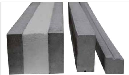
Die DRGpor HW 140 Konstruktionsplatte besteht aus einem hochverdichteten, expandierten, formgeschäumten, hydrophobierten Polystyrol-Hartschaum. Diese Konstruktionsplatte wird für eine hochwertige Unterkonstruktion Ihrer Fenster und Türen verwendet. Durch die hervorragenden Dämmeigenschaften schließt sie sämtliche Wärmebrücken aus.
