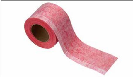
DRG-Fensteranschlussfolie innen besteht aus einem vollflächig selbstklebend überputzbaren Vliesverbund mit 1 SK-Streifen wahlweise mit Butylstreifen einseitig oder wechselseitig kaschiert. Die Anschlussfolie Innen dient zur schnellen und sicheren inneren, luftdichten und dampfbremsenden Abdichtung von Fensteranschlussfugen und kann auch als überputzbare innere Abdichtung verwendet werden.
