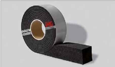
Das DRG-Multiband 3D ist ein neues speziell imprägniertes vorkomprimiertes Multifunktionsband zur Luft- und Schlagregenabdichtung sowie Dämmung von Fenster-Bewegungsfugen nach dem Prinzip „innen dichter als außen“.
