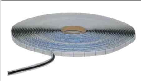
DRG-Butyl BON 217 ist ein volumenbeständiges, lösemittelfreies, selbstklebendes, plastisches und geräuschdämmendes Butyl-Dichtungsband. Es wirkt nicht korrodierend, ist mit den meisten bekannten Werkstoffen verträglich und entspricht den Anforderungen des IVD-Merkblattes Nr. 5.
