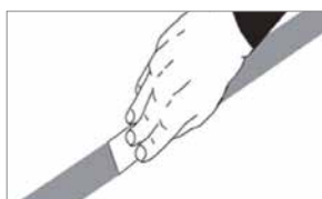
2. Klebeband aufbringen (wichtig: Klebefläche nicht berühren) und mit einer Spachtel kräftig andrücken
