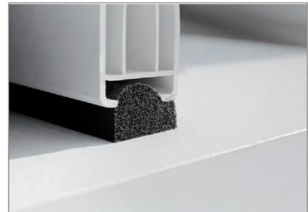
Das DRG-Multiband 3D ist ein neues speziell imprägniertes vorkomprimiertes Multifunktionsband zur Luft- und Schlagregenabdichtung sowie Dämmung von Fenster-Bewegungsfugen nach dem Prinzip „innen dichter als außen“.
