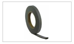
Das DRG-Vorkomprimierte Fugendichtband BG1 (600 Pa) aus imprägniertem Schaumstoff dient zur Primärabdichtung bei direkt bewitterten Fugen und Anschlüssen zwischen Fassadendämmsystemen und angrenzenden Bauteilen bis 600 Pa. Durch das spezielle Expansionsverhalten ist es für die Erstellung komplexer Anschlüsse (z.B. von Fensterbänken) geeignet.
