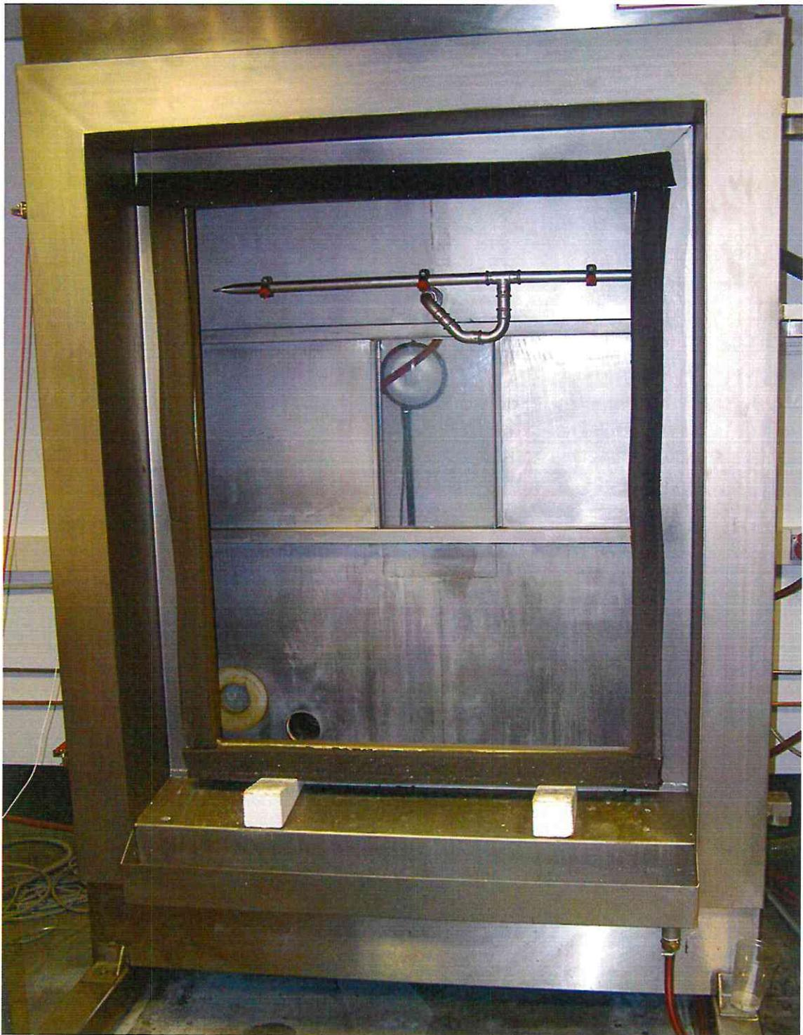
Bild 1: Offener Prüfstand ohne den eingesetzten Versuchskörper
