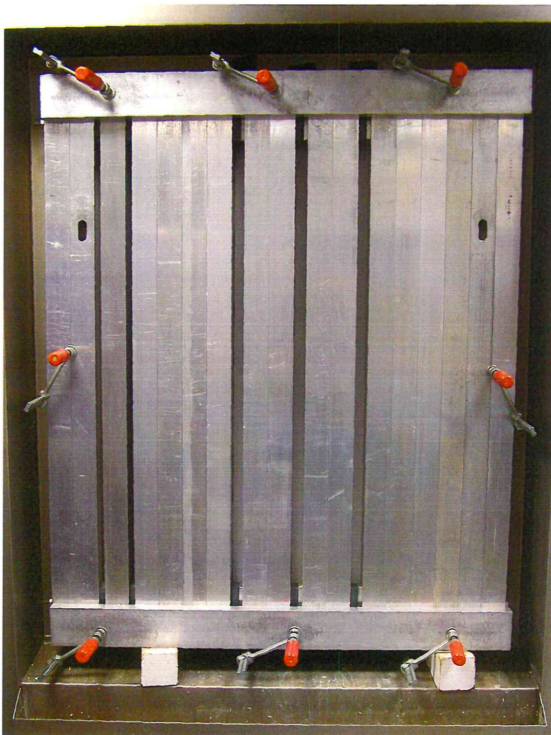
Bild 5: Versuchskörper eingebaut im Prüfstand
