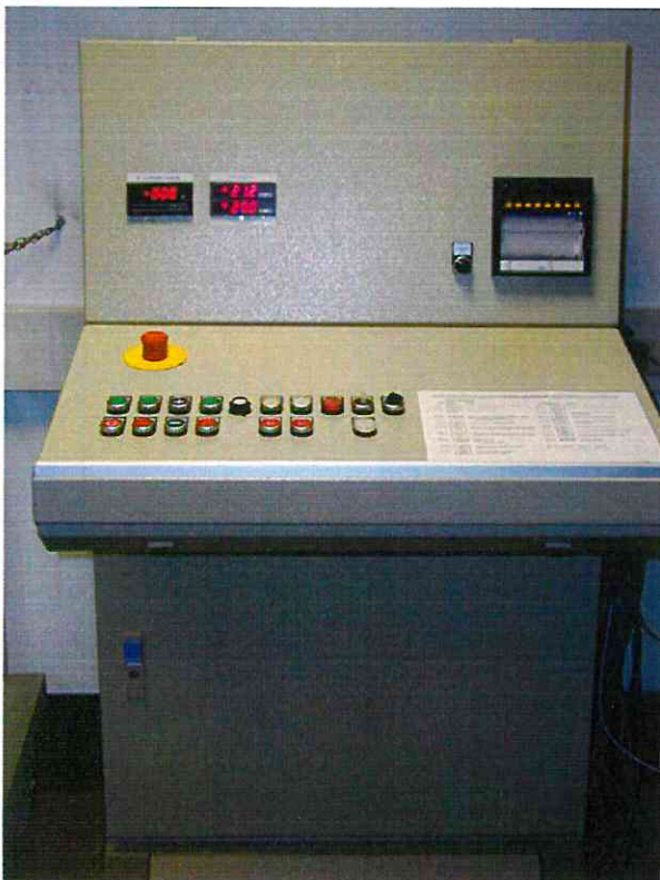
Bild 3a: Prüfstand-Steuerung (Drucksteuerung)
