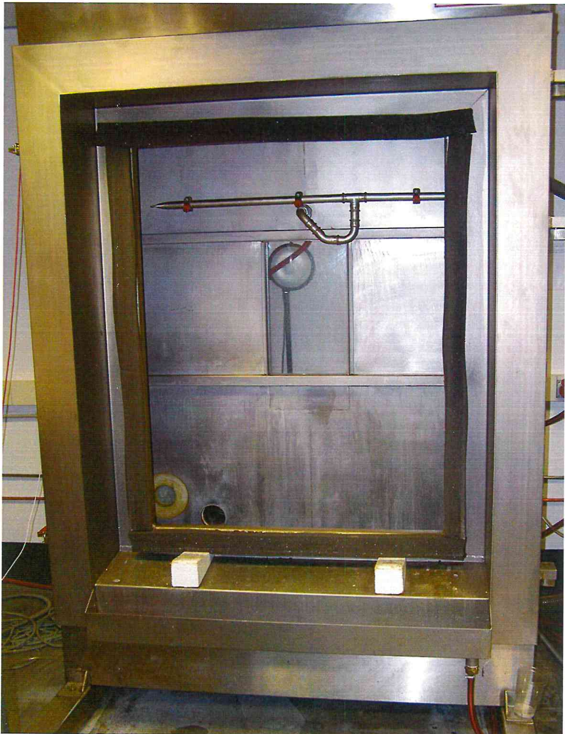
Bild 1: Offener Prüfstand ohne den eingesetzten Versuchskörper
