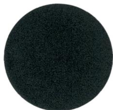
DRG-Bio-EPDM-L schwarz ist ein geschlossenzelliger und weichelastischer Zellgummi aus mind. 80% nachwachsender, nachhaltiger oder ISCC-zertifizierter Rohstoffe und verfügt über eine Zellgröße von  $\leq 0,5$  mm.
