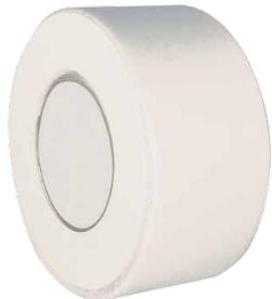
DRG folija za spojeve na prozorima TWINA može se prežbukati i sastoji se od tkanog flisa jednostrano ili obostrano kaširanog samoljepljivom odnosno butil trakom. Folija za spojeve služi za brzo i sigurno neprodušno i paronepropusno unutarnje brtvljenje na spojevima prozora i može se koristiti i kao unutarnje brtvište koje se može prežbukati.
