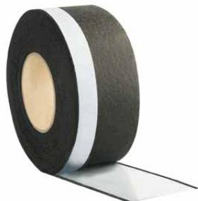
DRG vanjska folija za spojeve na prozorima može se prežbukati i sastoji se od tkanog flisa jednostrano ili obostrano kaširanog samoljepljivom odnosno butil trakom. Vanjska folija za spojeve služi za brzo i sigurno paropropusno i vodonepropusno vanjsko brtvljenje na spojevima prozora i koristi se kao vanjsko brtvište koje se može prežbukati.
