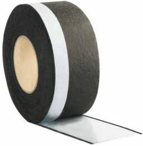
La pellicola di collegamento per finestre DRG per l'esterno è costituita da un composito non tessuto intonacabile laminato su un lato o alternativamente con butile o autoadesivo. La pellicola di collegamento per l'esterno viene utilizzata per la sigillatura esterna rapida e sicura, a prova di pioggia battente e a diffusione aperta dei giunti di connessione delle finestre e viene utilizzata come guarnizione esterna intonacabile.
