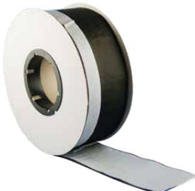
Zunanja zaključna okenska folija DRG je izdelana iz vezane mrežice, enostransko ali izmenično kaširane z butilom oz. samodejnim lepilom, in je primerna za ometanje. Zunanja zaključna folija služi za hitro in varno zunanjo, vodo-vetrovno tesno in paropropustno tesnjenje okenskih spojev in se uporablja kot zunanje tesnjenje, na katero se lahko nanaša omet.
