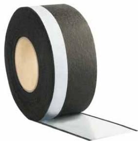
DRG spoljašnja zaptivna folija za preklope i ivice oko prozora sastoji se od premazive, jednostrano ili dvostrano lepljive, platnene trake na bazi butila odn. samolepljivosti. Spoljašnja zaptivna folija služi za brzo i pouzdano spoljašnje zaptivanje preklopa i ivica na prozorima koja je propustljiva i otporna na jaku kišu sa naletima vetra i može da se premazuje.
