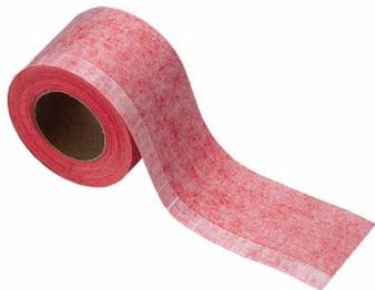
DRG unutarnja folija za spojeve na prozorima može se prežbukati i sastoji se od tkanog flisa jednostrano ili obostrano kaširanog samoljepljivom odnosno butil trakom. Unutarnja folija za spojeve služi za brzo i sigurno neprodušno i paronepropusno unutarnje brtvljenje na spojevima prozora i može se koristiti i kao unutarnje brtvilo koje se može prežbukati.
