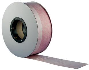
La pellicola di collegamento alla finestra DRG per l'interno è costituita da un composito non tessuto inonacabile su un lato o alternativamente con butile o con butile o autoadesivo. La pellicola di collegamento per l'interno viene utilizzata per la sigillatura interna rapida e sicura, a tenuta d'aria e con barriera al vapore dei giunti di connessione delle finestre e può essere utilizzata anche come sigillante interno inonacabile.
