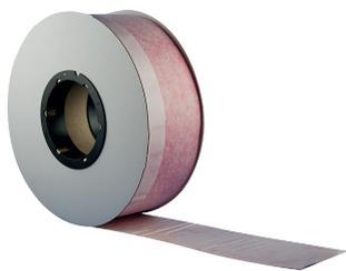
Notranja zaključna okenska folija DRG je izdelana iz vezane mrežice, enostransko ali izmenično kaširane z butilom oz. samodejnim lepilom, in je primerna za ometanje. Zaključna folija služi za hitro in varno notranjo zrakotesno in paropropustno tesnjenje okenskih zaključnih spojev in se uporablja kot notranje tesnjenje, na katero se lahko nanaša omet.
