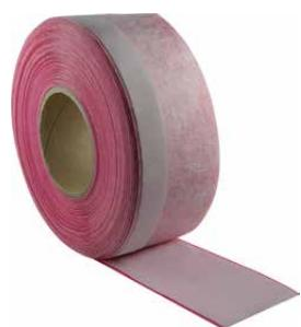
DRG unutrašnja zaptivna folija za preklope i ivice oko prozora se sastoji od premazive, jednostrano ili dvostrano lepljive, platnene trake na bazi butila odn. samolepljivosti. Unutrašnja zaptivna folija služi za brzo i pouzdano unutrašnje zaptivanje preklopa i ivica na prozorima, ne propušta vazduh niti vodenu paru i može da se premazuje.
