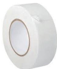
DRG-Folienklebeband 98611 è un nastro sigillante per l'impermeabilizzazione energetica dei tetti a falde. Grazie alle sue proprietà adesive universali, è adatto come nastro adesivo di sistema per l'incollaggio di strati di controllo del vapore commercialmente flessibili, membrane di isolamento e pannelli a base di legno, così come le loro transizioni in corrispondenza di sovrapposizioni, giunti, collegamenti e penetrazioni.
