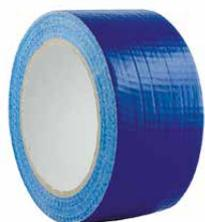
Das DRG-Gewebeband blau ED05 ist von -35 bis +80 C° temperaturbeständig. Das hochwertige PE-beschichtete Gewebeband wird für Abdeck- und Abklebarbeiten eingesetzt. Es besitzt eine sehr gute Witterungs- und UV-Beständigkeit und ist im Innen- und Außenbereich verwendbar. Von den meisten Oberflächen nach 28 Tagen rückstandsfrei entfernbar. (Bitte vorher prüfen!)
