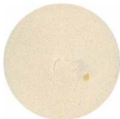
DRG-HY/EPDM mittel ist ein geschlossenzelliger und weichelastischer Zellgummi und ist ABS-verträglich. Dieses Produkt sollte nicht über längere Zeit dem unmittelbaren Witterungseinflüssen ausgesetzt werden. Bei Freibewitterung versprödet und verfärbt sich die Oberfläche etwas.
