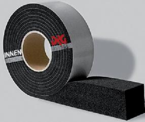
Il Multiband 3D della DRG è un nuovo nastro multifunzionale preimpregnato appositamente impregnato per sigillare l'aria e la pioggia battente, nonché per isolare i giunti di movimento delle finestre. Zone speciali nel nastro con densità diverse garantiscono la tenuta secondo il principio "più stretto all'interno che all'esterno".
