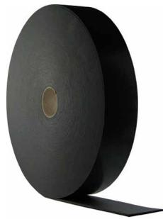
Das DRG-Trennwandband wird zur thermischen und akustischen Entkoppelung von GKF-Metalständerwänden verwendet. Die Baustoffklasse B1 schwerentflammbar nach DIN 4102 wird erreicht, wenn das Band im eingebauten Zustand um die Hälfte seiner Ausgangsstärke komprimiert ist.
