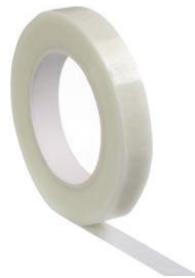
DRG-Übertragungsklebeband 11.347-72 ist ein Haftklebefilm mit hochwirksamen Haftklebstoff aus lösungsmittelfreiem, alterungsbeständigem Polyacrylat mit ausgewogenen Eigenschaften bezüglich Tack, Klebkraft und Scherfestigkeit, insbesondere auch aufgrund des faserverstärkenden Effektes des Polyestergelees.
