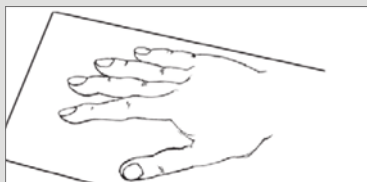
Abdeckfolie abziehen und Objekt mit hohem Druck aufkleben
