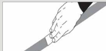
Klebeband aufbringen (wichtig: Klebefläche nicht berühren) und mit einer Spachtel kräftig andrücken
