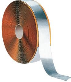
DRG-Alu-Butyl Tackband AD ist ein selbstklebendes, volumenbeständiges Butylband, das mit einer reißfesten Alufolie unlösbar kaschiert ist und für die abdeckende Dichtung von Konstruktions- und Anschlußfugen im Industrie- und Baubereich hervorragend geeignet ist.
