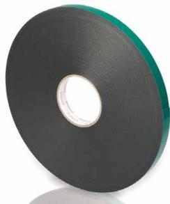
DRG-Coro 4247/4242 F ist ein doppelseitiges Klebeband für hohe Anforderungen. Das Produkt zeichnet sich durch eine gute Anfangs- und hervorragende Endklebekraft aus. Der geschlossenzellige PE-Schaum ist dauerelastisch, schwingungsdämpfend und passt sich den Fügepartnern sehr gut an.
